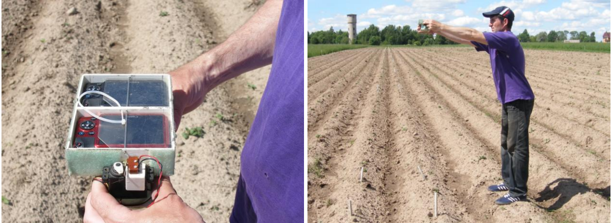
Рисунок 8 – Наземная фотосъемка двумя зеркальными камерами в видимом и ближнем инфракрасном диапазонах
