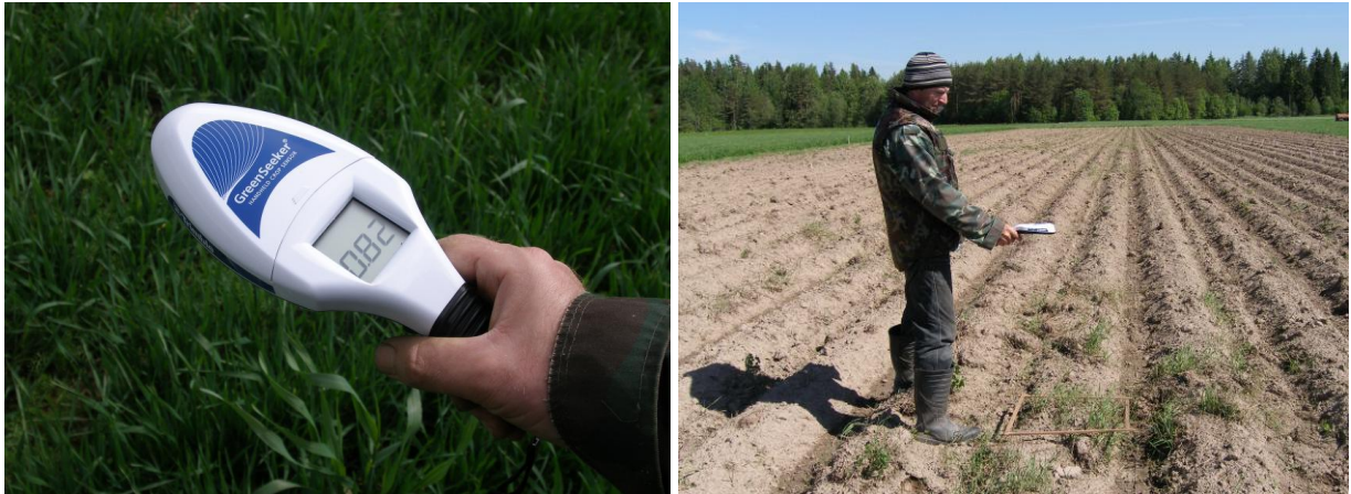
Рисунок 7 – Проведение измерений портативным ручным датчиком GreenSeeker
