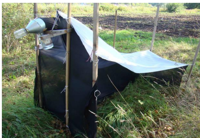
Рис. 28. Ловушка Малеза в питомнике СПбГАУ
